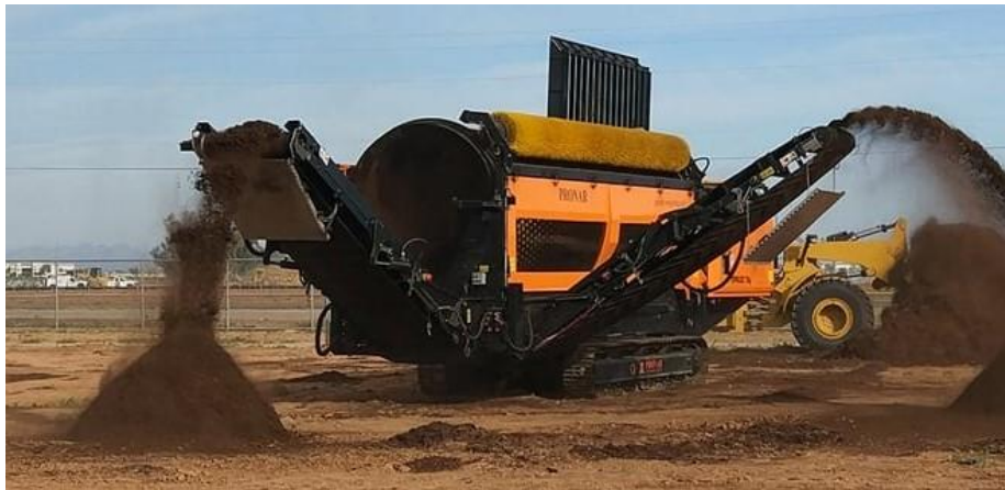
Esempio di vaglio montato su cingoli con carico autonomo
