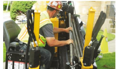
**OPZIONI DIVERSE DI ASTE.** Completa il tuo perforatore con aste Firestick da 1,8 m, diametro 4,2 o 3,3 cm e risparmia tempo grazie alla capacità di carico di 55 m di aste sulla macchina.
