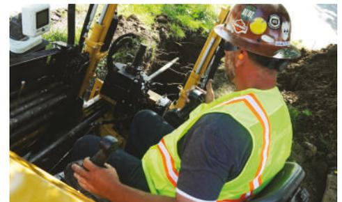
**RUMOROSITA' RIDOTTA.** Emissioni sonore ridotte, pari a 85dBa all'orecchio dell'operatore, e una rumorosità massima garantita pari a 104dBa rendono questo perforatore perfetto per lavorare in ambito urbano riducendo al minimo il disturbo della popolazione.
