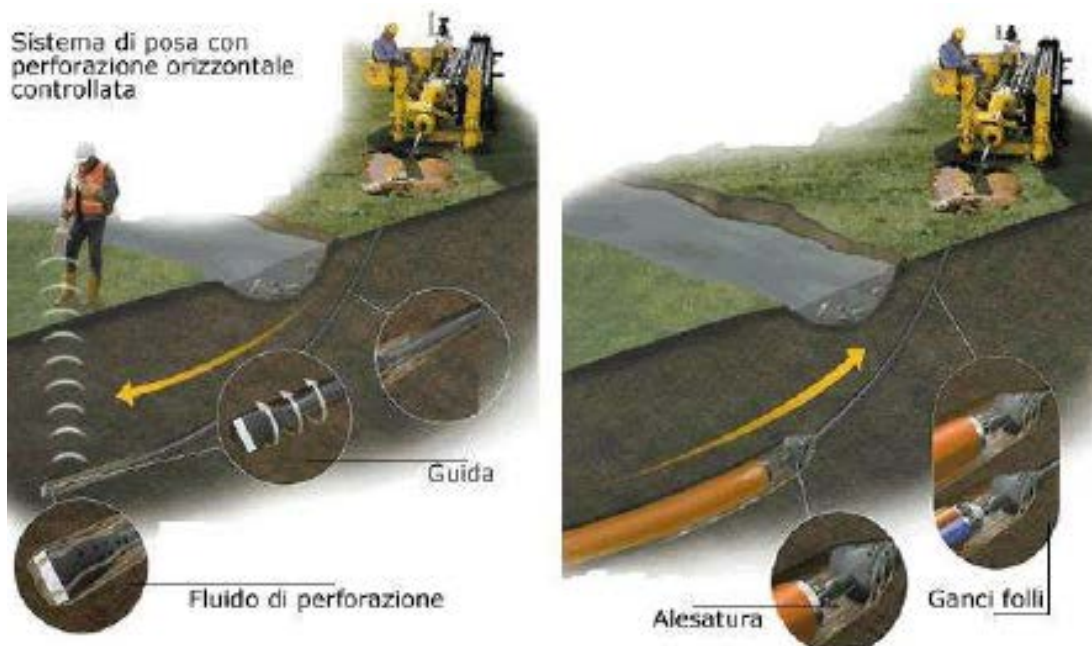
Posa in opera tubazione con trivellazione teleguidata
