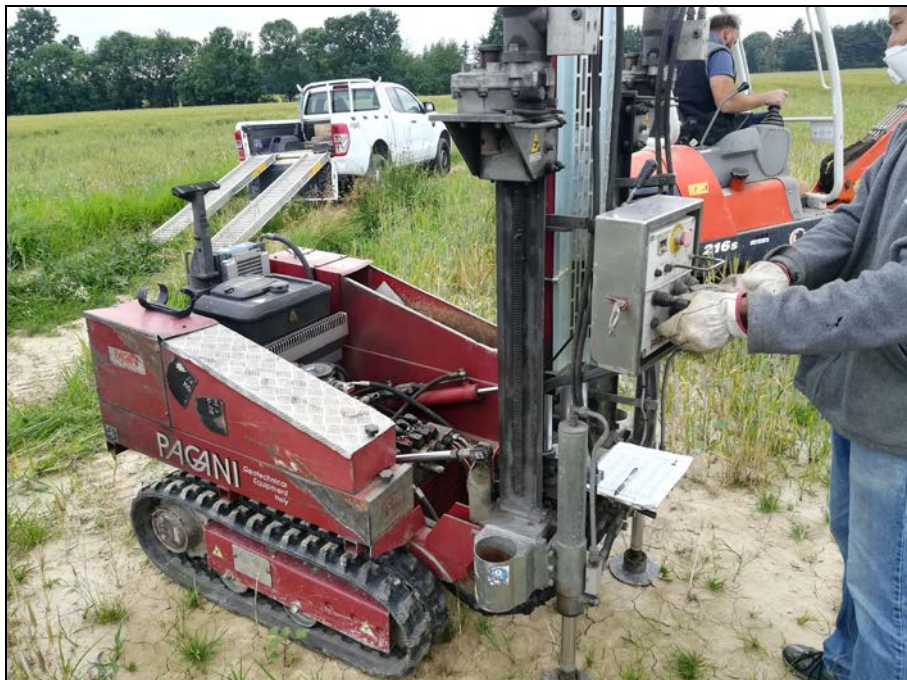
Foto 1: fase di realizzazione della prova penetrometrica DIN1.
