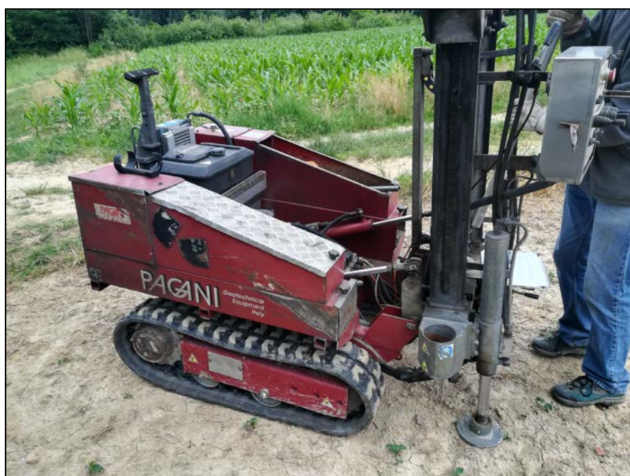
Foto 3: fase di realizzazione della prova penetrometrica DIN2.
