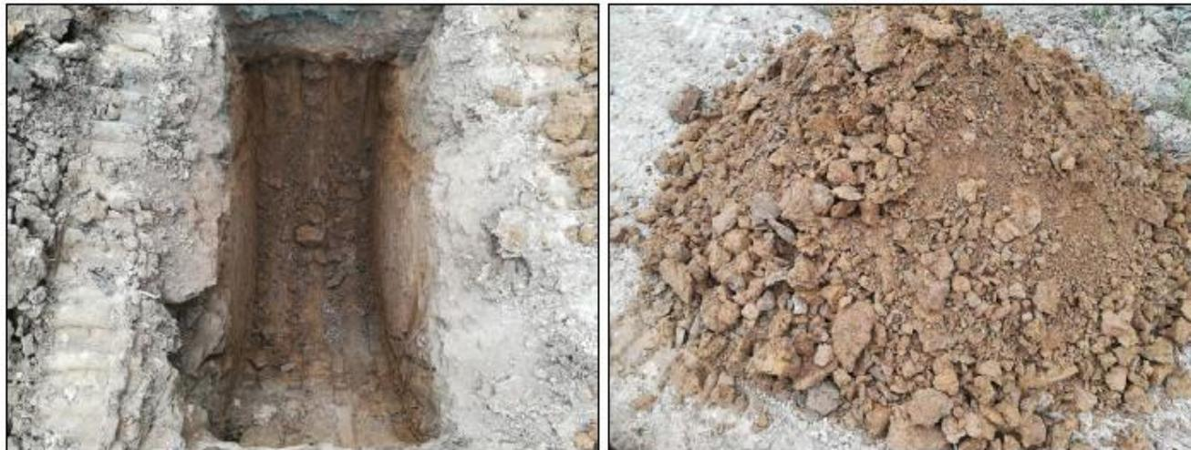
*Figura 4.5: fase di realizzazione del pozzetto geognostico P2 (a sinistra) e materiale estratto (a destra).*
