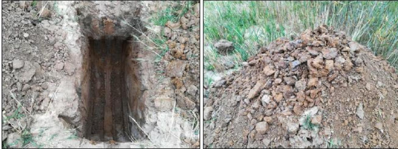
*Figura 4.4: fase di realizzazione del pozzetto geognostico P1 (a sinistra) e materiale estratto (a destra).*
