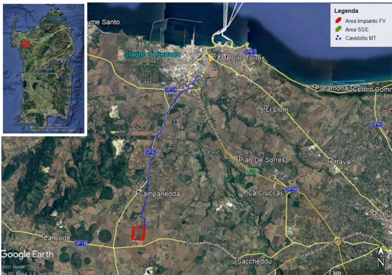
Inquadramento generale su Orto-foto (in rosso le aree di impianto, in verde l'area della SSE Utente)
