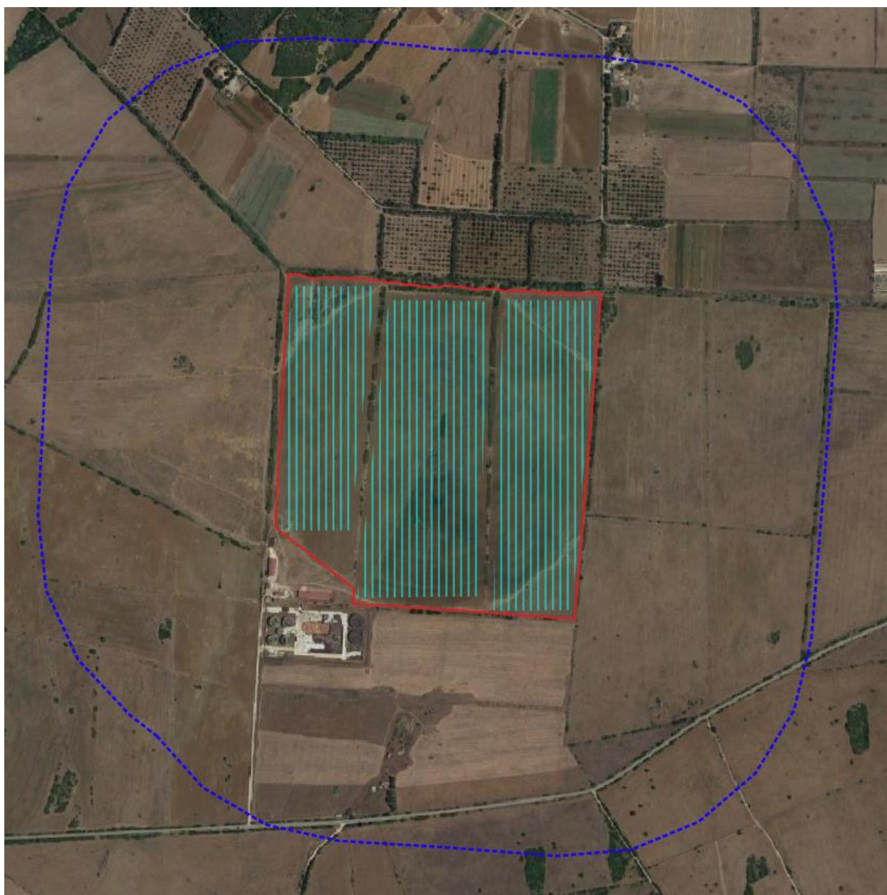
Limite area impianto fotovoltaico (in rosso), tracker (in azzurro) e limite area indagine agronomica (in blu)
