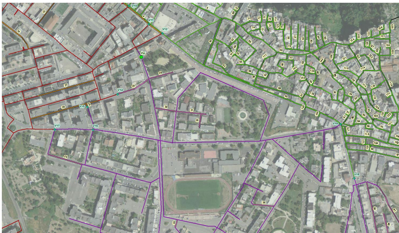
Figura 2-4: Valvole di sezionamento per la creazione dei distretti
