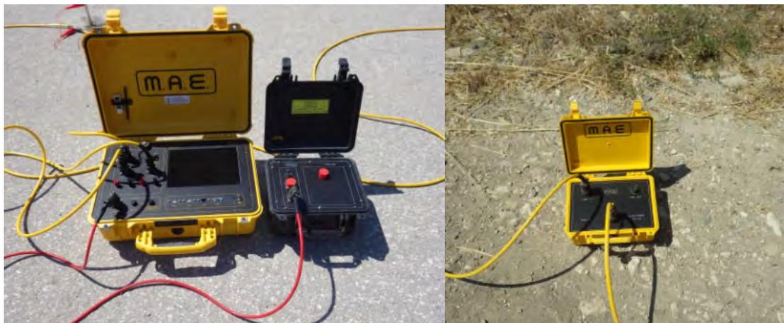
Fig. 12. Sistema A6000-E e relativo box di commutazione esterno.
