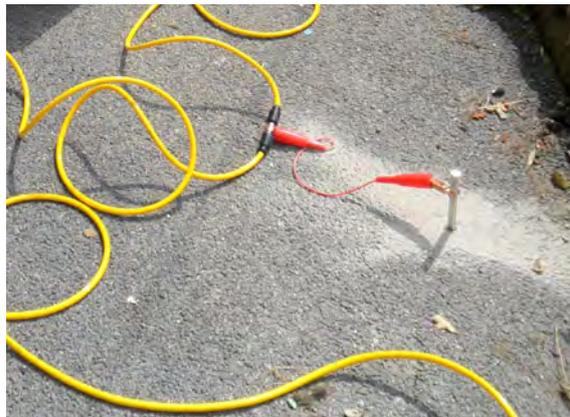
Fig. 2 – Elettrodo costituito da picchetto in acciaio inox utilizzato per le indagini geoelettriche effettuate.
