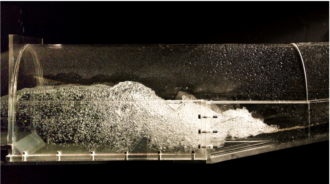
Figura D.3. Funzionamento della vasca di dissipazione per una portata di 11.32 l/s, corrispondenti a 200 mc/s nel prototipo.
