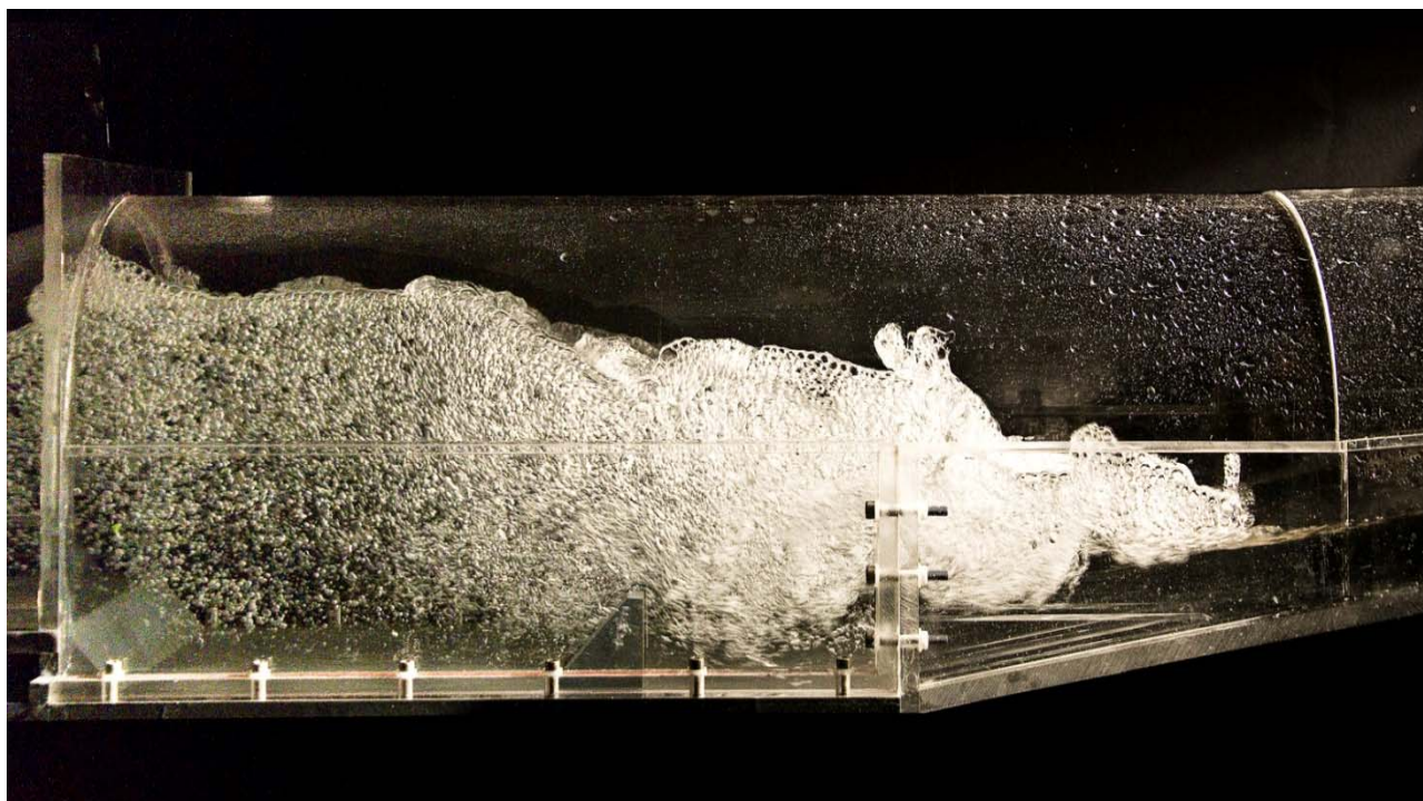
Figura D.4. Funzionamento della vasca di dissipazione per una portata di 18.78 l/s, corrispondenti a 332 mc/s nel prototipo.
