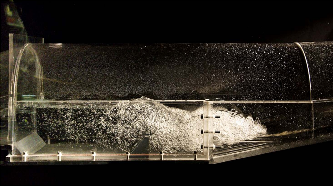
Figura D.2. Funzionamento della vasca di dissipazione per una portata di 6.79 l/s, corrispondenti a 120 mc/s nel prototipo.
