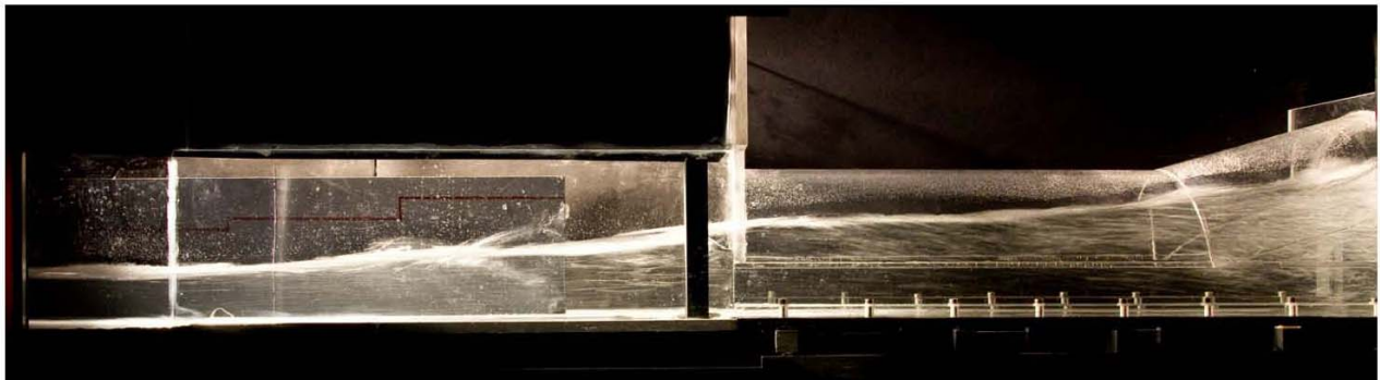
Figura D.8. Profilo della corrente nel tratto a valle della vasca di dissipazione per una portata di 18.78 l/s, corrispondenti a 332 m 3 /s nel prototipo.
