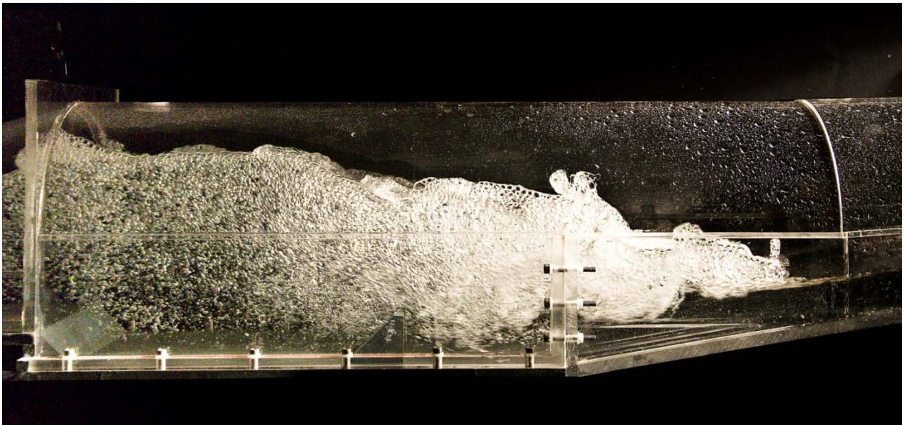
Figura 6. Risalto idraulico nella vasca di dissipazione per una portata di 18.78 l/s, corrispondenti a 332 m 3 /s nel prototipo.
