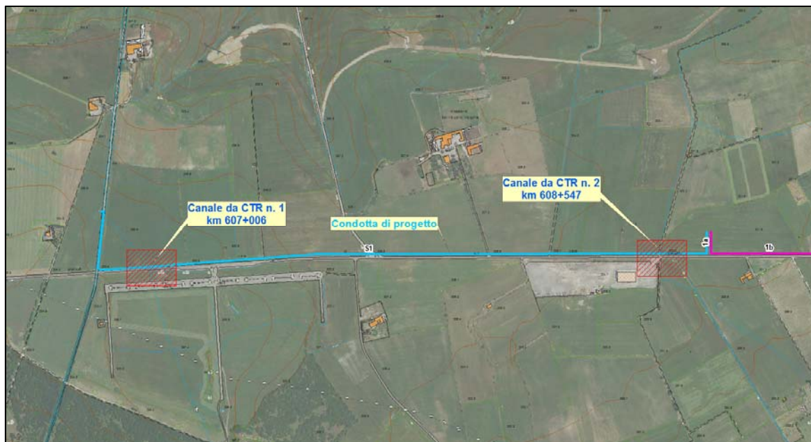
Figura 43- Stralcio planimetrico con individuazione delle interferenze dell'intervento ID S1 con i Canali da CTR n.1 e n.2
