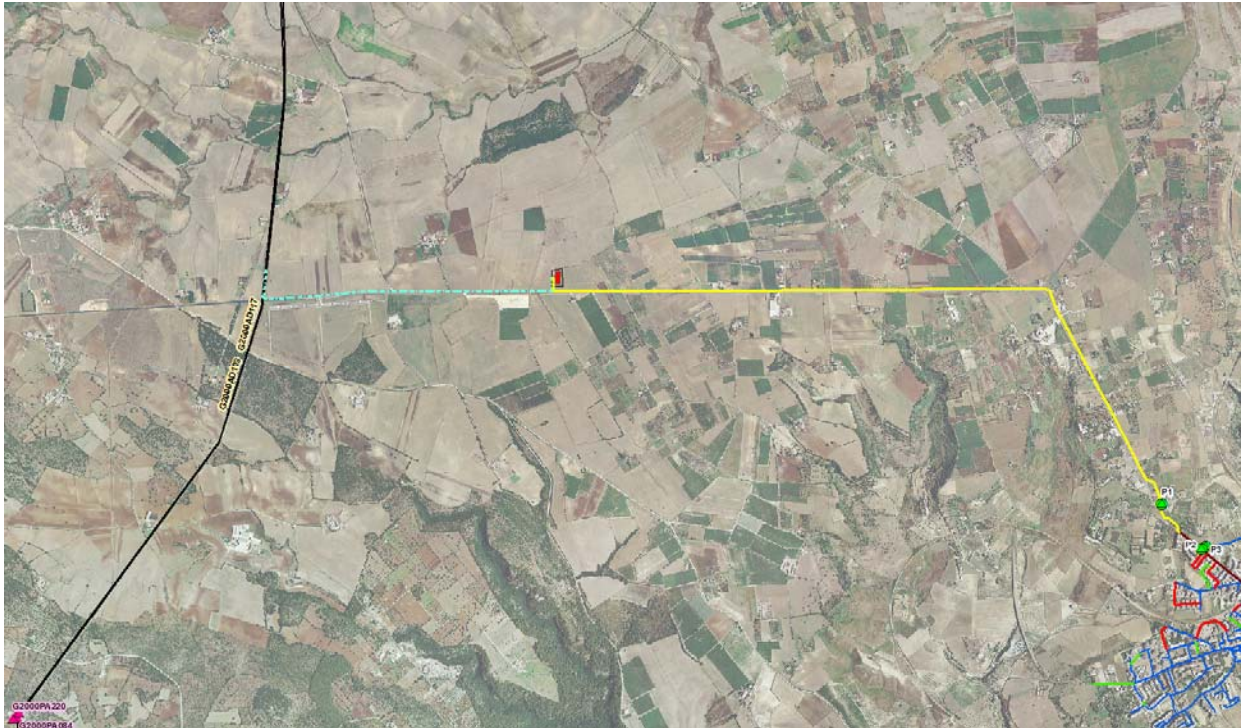
Figura 5 – Interventi di progetto della rete idrica di adduzione: in giallo la suburbana.
