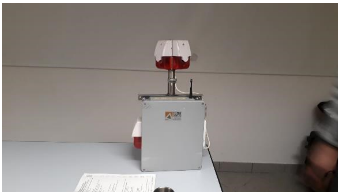
Fig. 7. Unità d'allarme per le maestranze di cantiere dotata di dispositivo acustico/luminoso.
