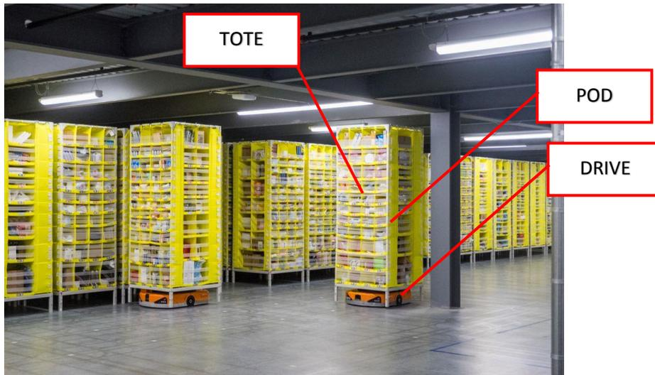
*Figura 3 – Esempio di Scaffali in posizione di stoccaggio e di trasporto*
