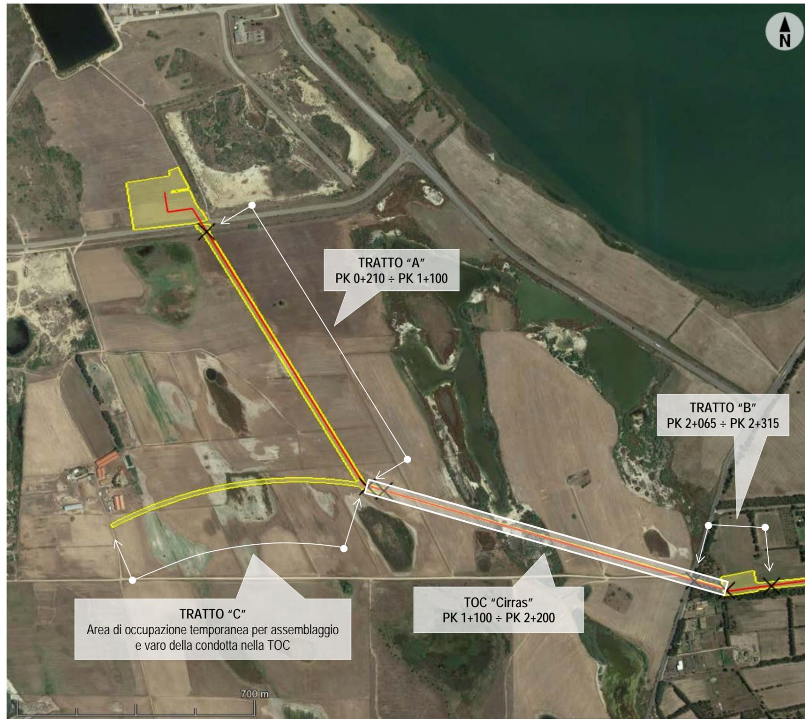
Figura 2-2: Met. Coll. Terminale di Oristano DN 650 | Tratti "A" "B" e "C" interferenti con l'area umida
