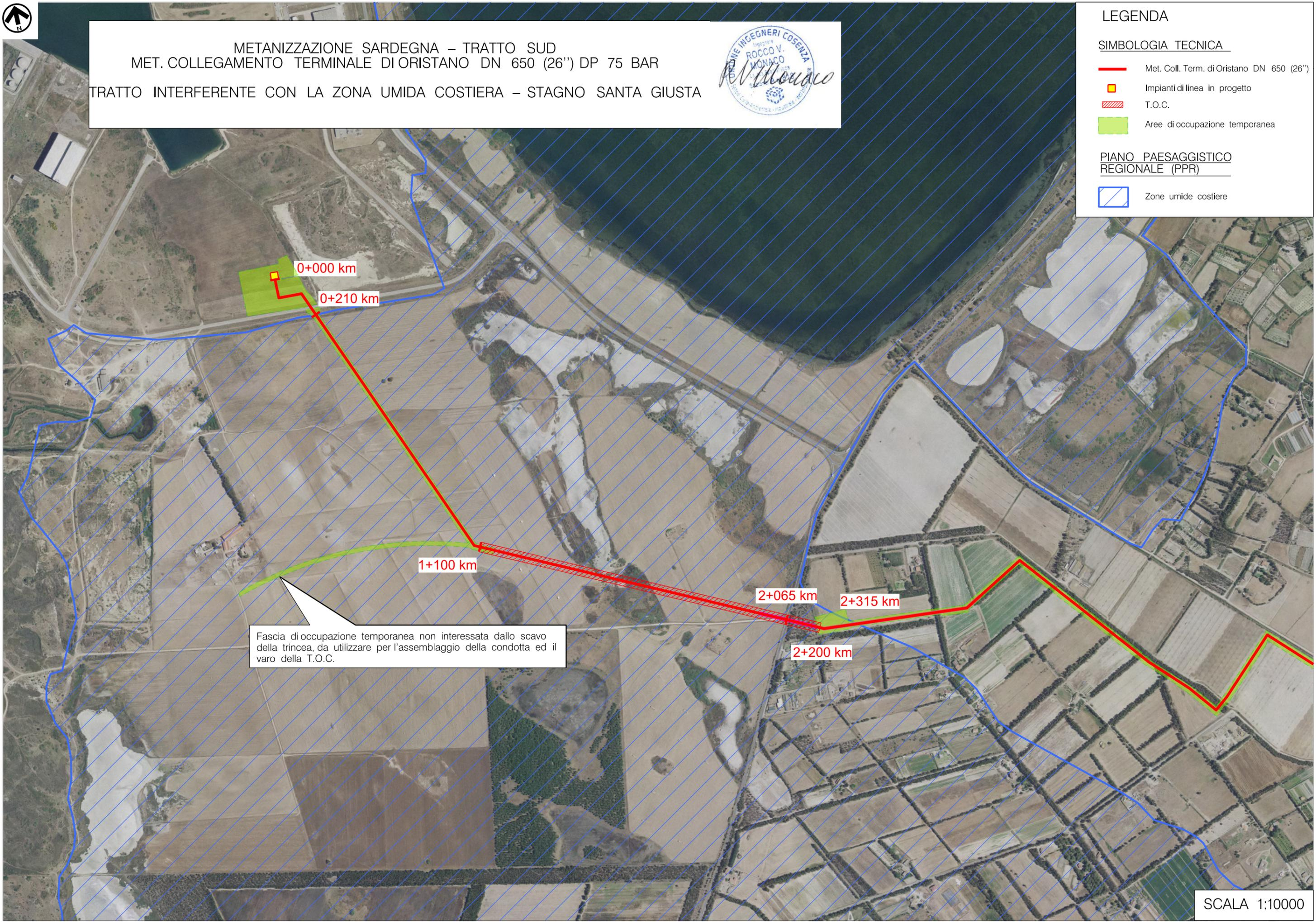
Fascia di occupazione temporanea non interessata dallo scavo della trincea, da utilizzare per l'assemblaggio della condotta ed il varo della T.O.C.
