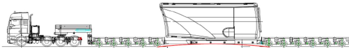
**Figura 8** Schema tipo per il trasporto della navicella
