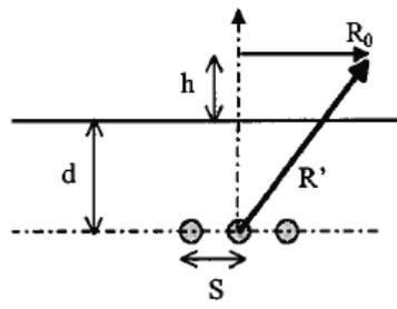
**Figura 11 – Schema di principio per il calcolo delle distanze da terne di cavi interrati con posa in piano oltre le quali l'induzione magnetica è inferiore all'obiettivo di qualità ( $d$  è la profondità del centro del conduttore)**
