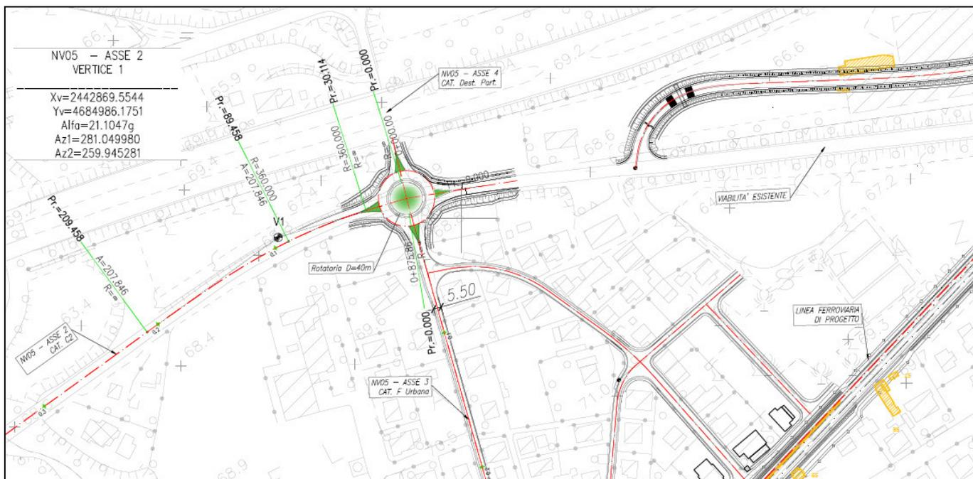
Fig. 29 – NV05 - Adeguamento viabilità - S.S. 5 "Via Tiburtina" (Inserimento rotatoria)
