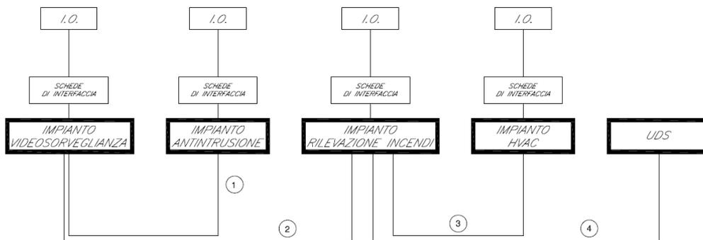
La centrale controllo accessi – antintrusione, inoltre, potrà essere interfacciata con lo switch del sistema di supervisione per la gestione e il controllo remoto.
