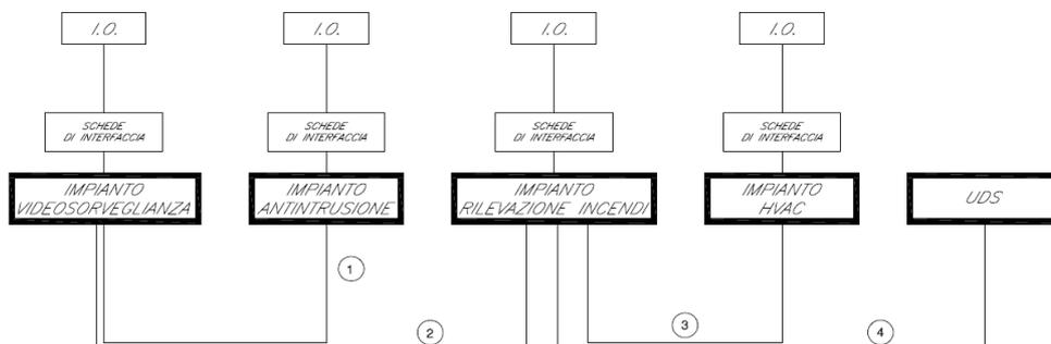
Per il collegamento con il sistema di supervisione la centrale TVCC dovrà essere dotata di apposita interfaccia e linguaggio di comunicazione basato su protocolli di comunicazione non proprietari.
