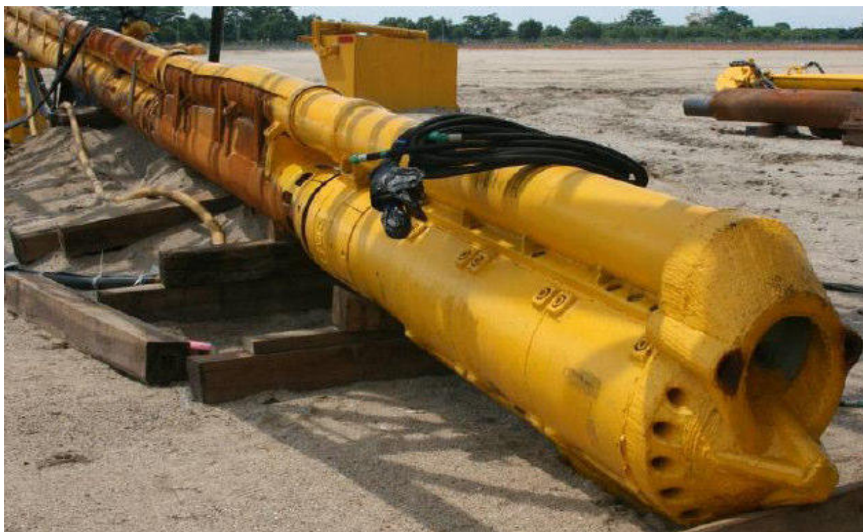
F 3. Dettaglio della punta dell'utensile e tubo di consegna ghiaia
