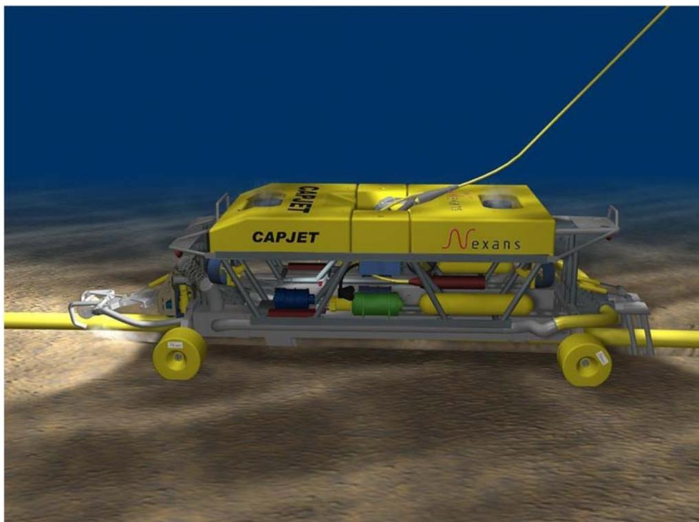
**Fig. 5** Macchina a getti d'acqua per l'interramento dei cavi
