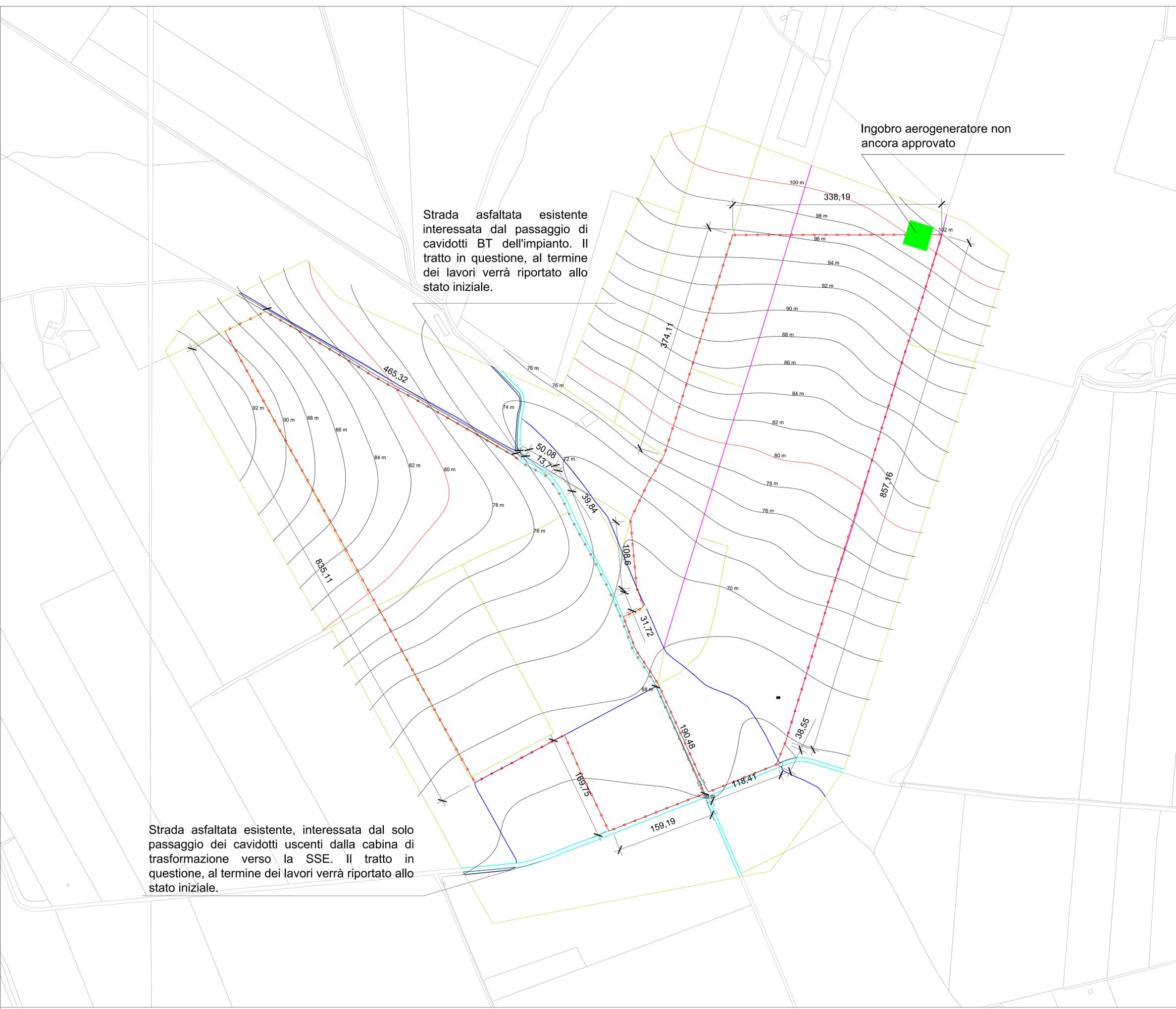
Strada asfaltata esistente interessata dal passaggio di cavidotti BT dell'impianto. Il tratto in questione, al termine dei lavori verrà riportato allo stato iniziale.
