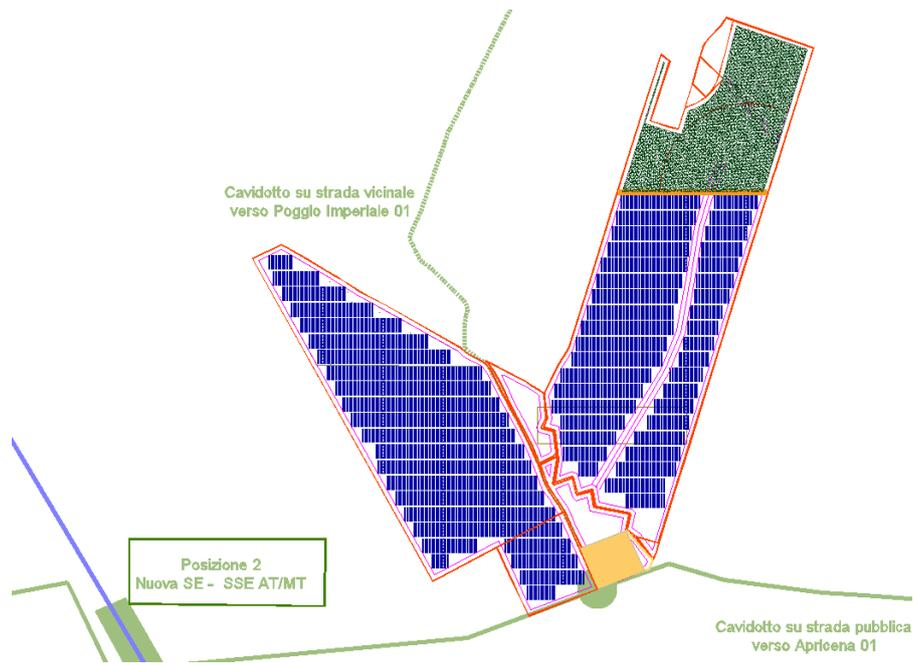
**fig.3.1**-stralcio del progetto preliminare impianto fotovoltaico mostrante disposizione dei pannelli
