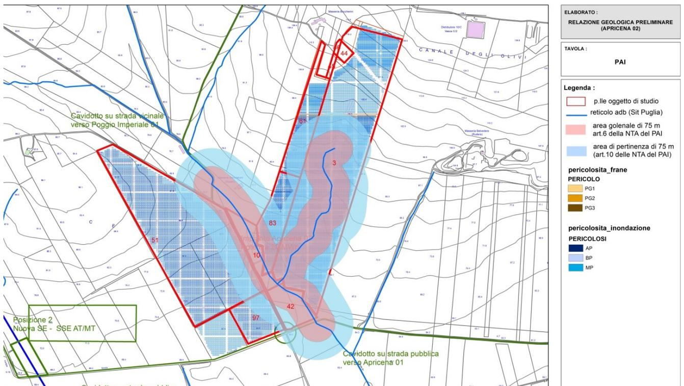
fig. 5.3.2-area golenale di 75 m e di pertinenza di 75 calcolata a partire dall'impluvio segnato nella carta idrogeomorfologica e sull'IGM
