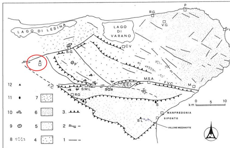
**Fig. 4.1.2**– Schema morfotettonico generale del promontorio del Gargano (da Caldara M. & Palmentola G.,1993, modificata). *Legenda: 1= faglia, 2= faglia trascorrente, 3= scarpata di linea di faglia, 4= altopiano centrale carsico, 5= regione dei terrazzi meridionali, 6= versante orientale di modellamento torrentizio, 7= regione dei terrazzi nord-occidentali, 8= polye, 9= dolina, 10= campi di doline, 11= grotta, 12= centri abitati con abbreviazione.*
