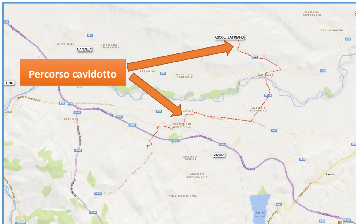
Figura 2 – Inquadramento del percorso del cavidotto di AT
