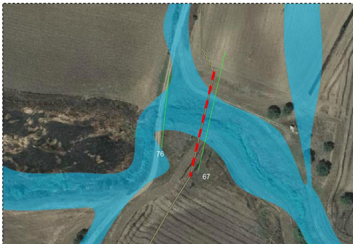
Fig. 17 Area “E Centro”. Particolare del tratto di cavidotto a realizzarsi con tecnica T.O.C
