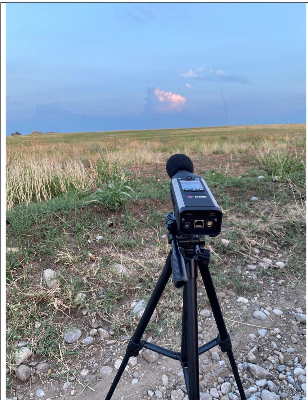
*Figura 17 – Misurazione fonometrica (Blocco A,B,C,D)*
