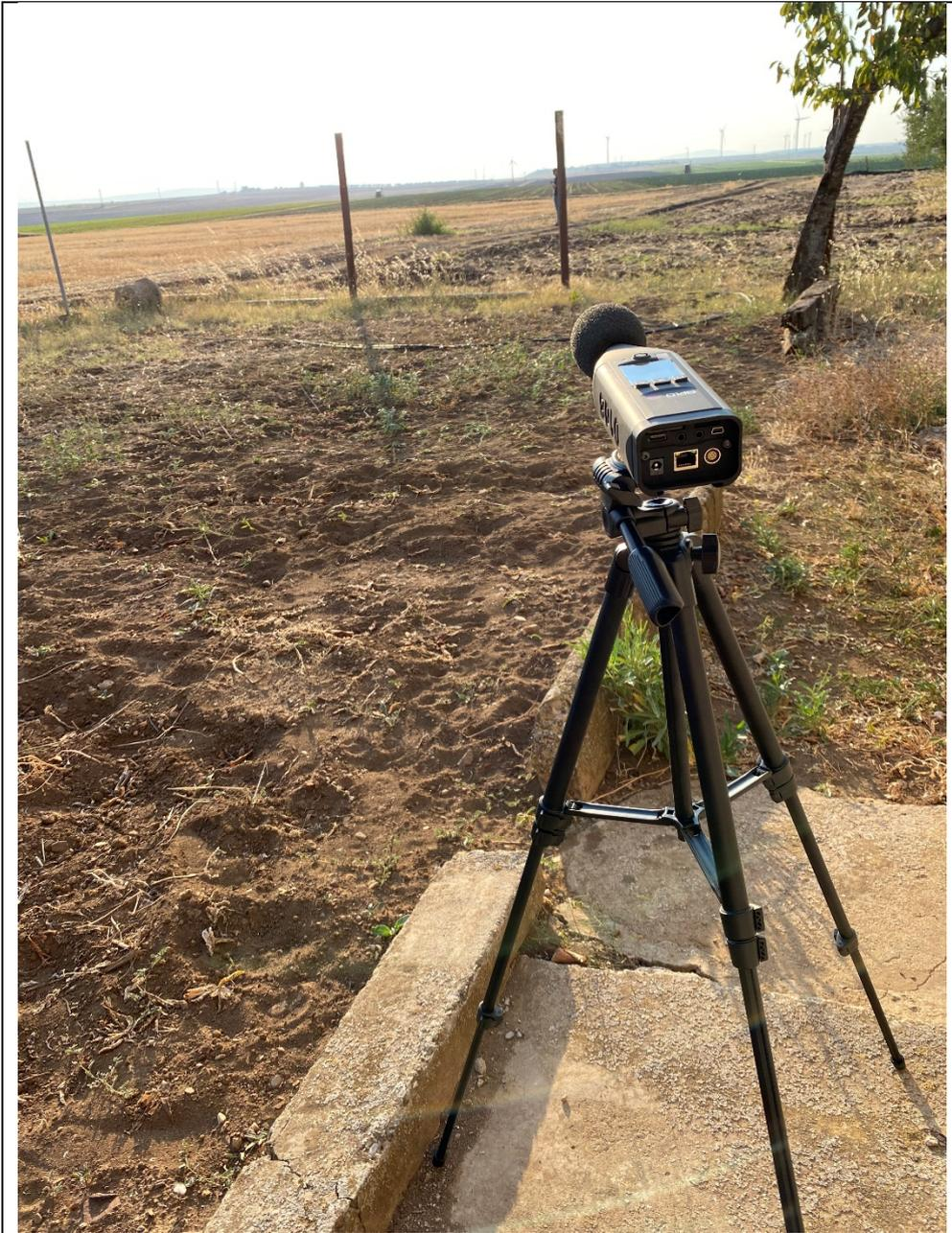
*Figura 15 – Misurazione fonometrica (Blocco E)*
