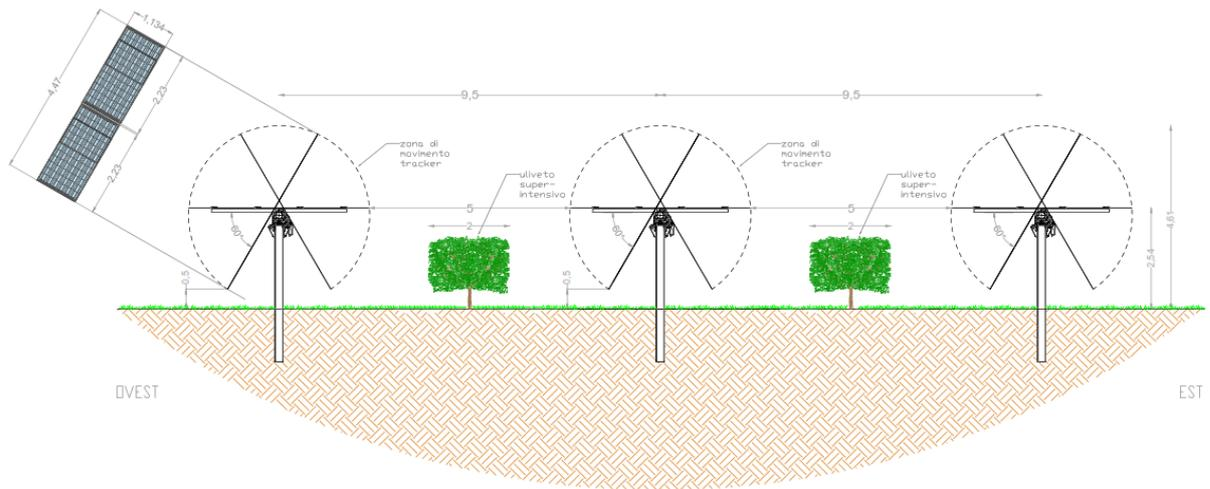
**Figura 2-12:** Schema impianto tracker nel sistema Agro-fotovoltaico
