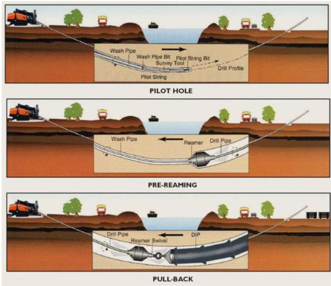
**Figura 3-37: Trivellazione orizzontale controllata -TOC**
