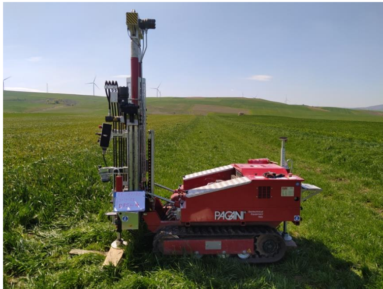
Prova penetrometrica DINAMICA DPHS 04
