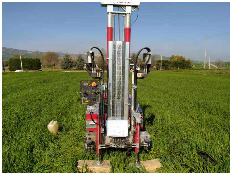
Prova penetrometrica DINAMICA DPSH 01
