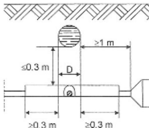
Un'altra soluzione, per ridurre la distanza di incrocio fino ad un minimo di 0,30 m è quella di interporre tra cavi energia e tubazioni metalliche un elemento separatore non metallico [come ad esempio lastre di calcestruzzo o di materiale isolante rigido]; questo elemento deve poter coprire, oltre la superficie di sovrapposizione in pianta delle strutture che si incrociano, quella di una striscia di circa 0.30 m di larghezza ad essa periferica
