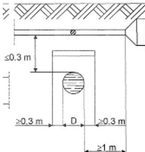
I manufatti di protezione e gli elementi separatori in calcestruzzo armato sono da considerarsi strutture non metalliche. Come manufatto di protezione di singole strutture con sezione circolare possono essere utilizzati collari di materiale isolante fissati ad esse.
