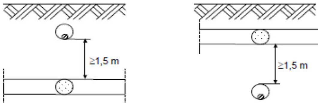
Qualora non sia possibile osservare tale distanza, la tubazione del gas deve essere collocata entro un tubo di protezione che deve essere prolungato da una parte e dall'altra dell'incrocio per almeno 1 m nei sottopassi e 3 m nei sovrappassi; le distanze vanno misurate a partire dalle tangenti verticali alle pareti esterne della canalizzazione; in ogni caso deve essere evitato il contatto metallico tra le superfici affacciate.
