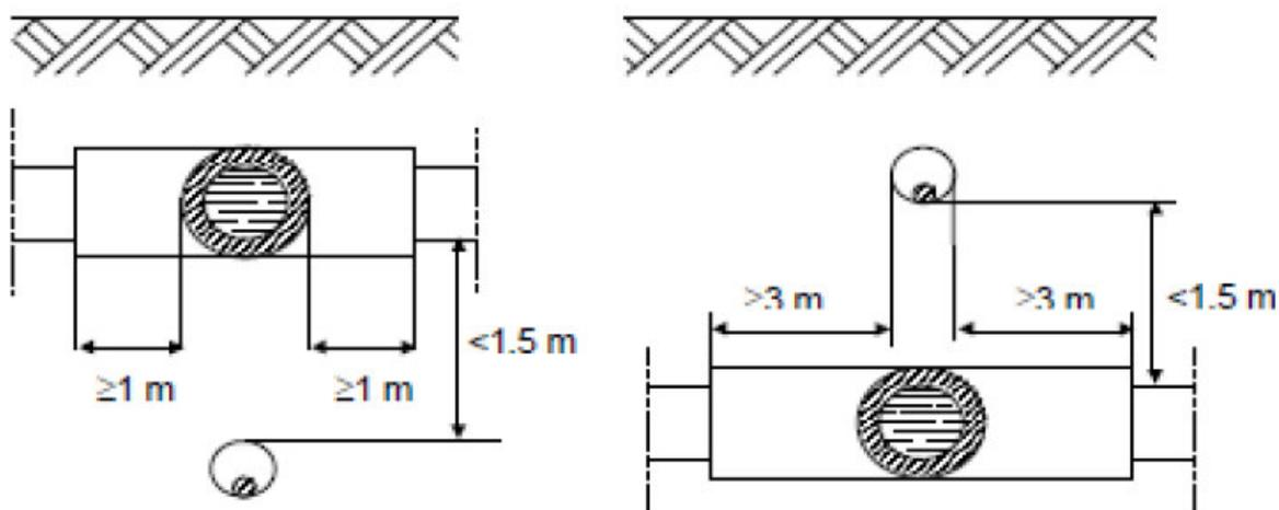
Nei parallelismi tra canalizzazioni per cavi elettrici e tubazioni non drenate, la distanza minima tra le due superfici affacciate non deve essere inferiore alla profondità di interrimento della condotta del gas, salvo l'impiego di diaframmi continui di separazione.
