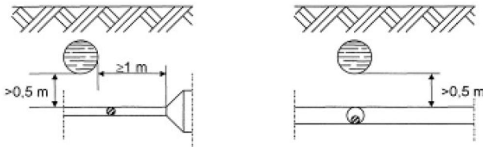
Tale distanza può essere ridotta fino ad un minimo di 0,30 m nel caso in cui una delle strutture di incrocio è contenuta in un manufatto di protezione non metallico prolungato almeno 0,30 m per parte rispetto all'ingombro in pianta dell'altra struttura.
