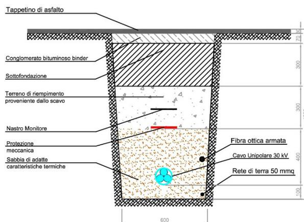
**Figura 1** Sezione tipica cavidotto interrato al di sotto di viabilità esistente
