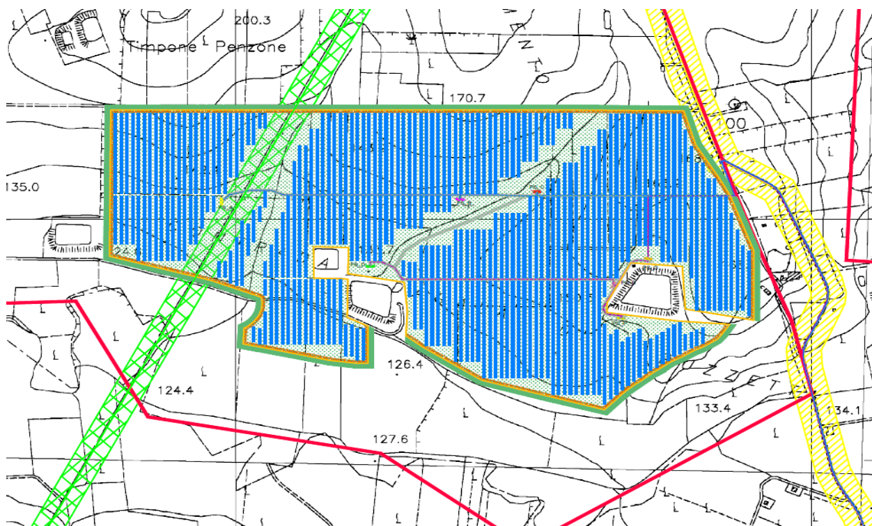
Figura 3 Layout impianto fotovoltaico su CTR
