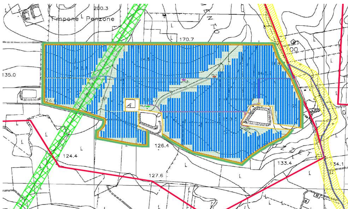
Figura 2 layout impianto fotovoltaico su CTR
