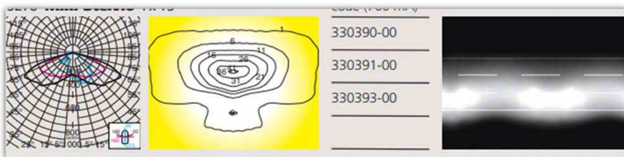
**La fotometrica di emissione a 90° rispetto al piano di emissione sarà inoltre pari a zero: nel caso specifico il proiettore presenta una fotometrica pari a zero già a 75°:**
