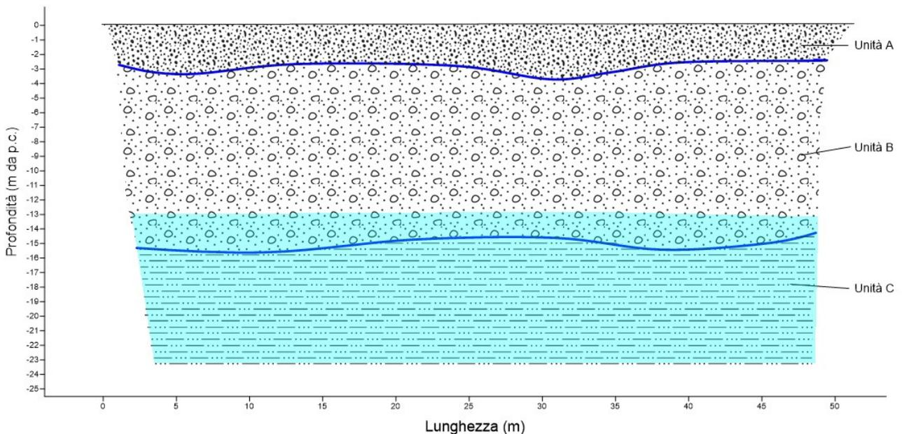
Fig. 11 - Modello geologico del sito su cui sarà realizzata la sottostazione di servizio.
