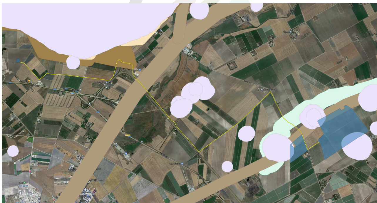
Figura 5-1: Individuazione delle aree non idonee, in blu la perimetrazione dell'impianto, in giallo il tracciato della connessione
