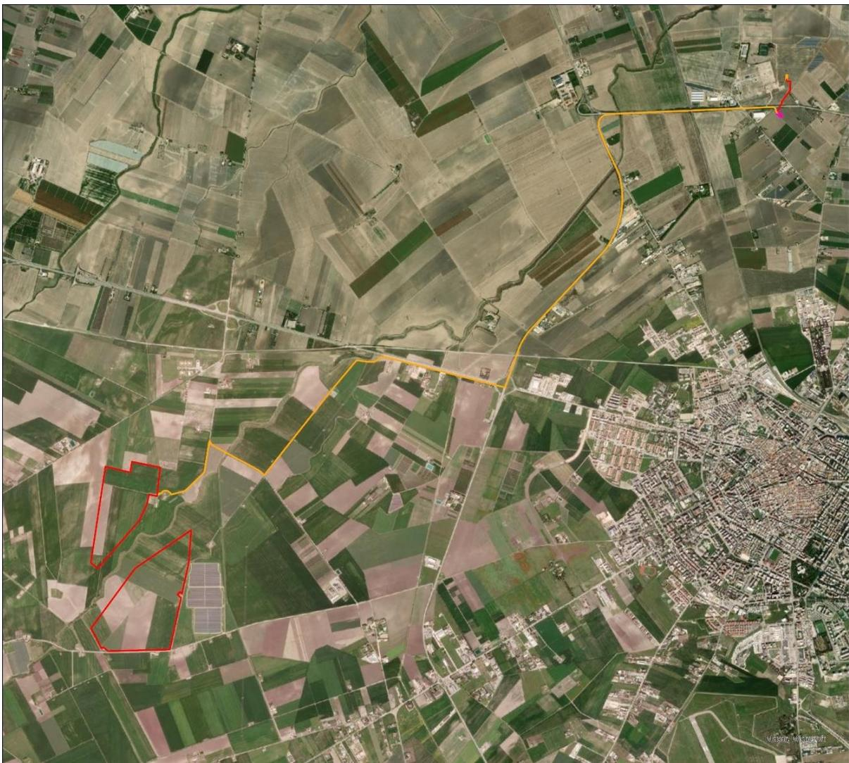
Figura 3.9: In arancio il percorso di connessione dal campo FV alla Sottostazione AT 380/150 kV Foggia
