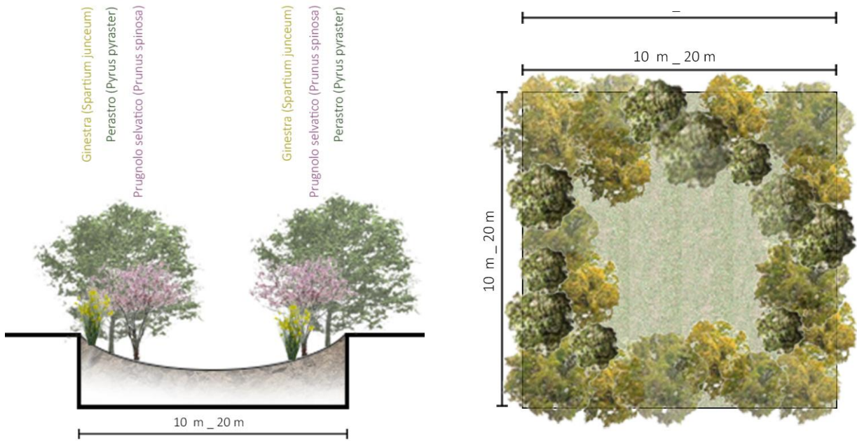
Figura 2.2 Tipologico del bacino di laminazione e infiltrazione.
