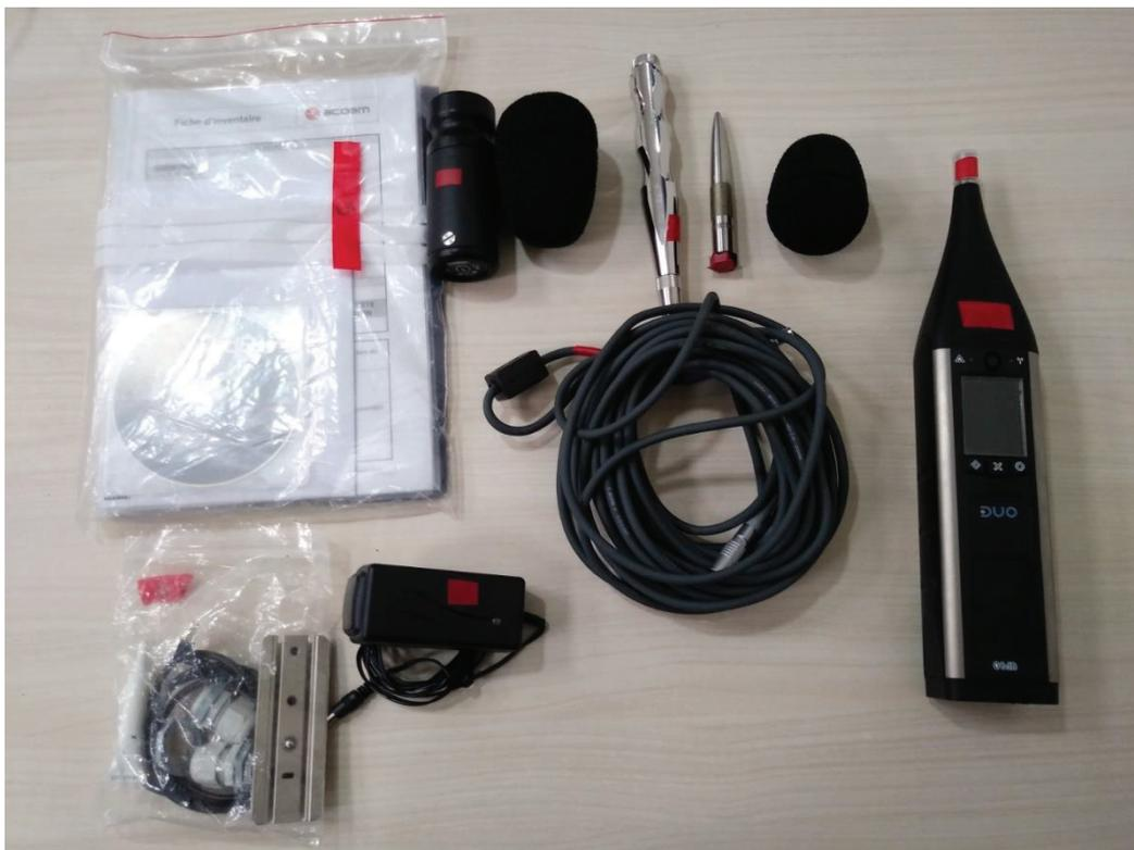
Figura 9.1: Fonometro e relativa strumentazione
