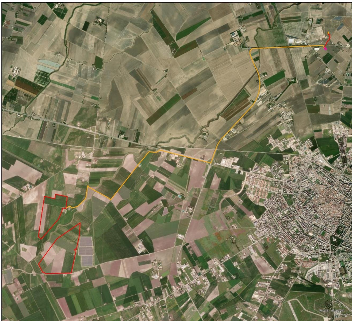
Figura 2.8: In giallo il percorso di connessione dal campo FV alla Sottostazione AT 380/150 kV Foggia
