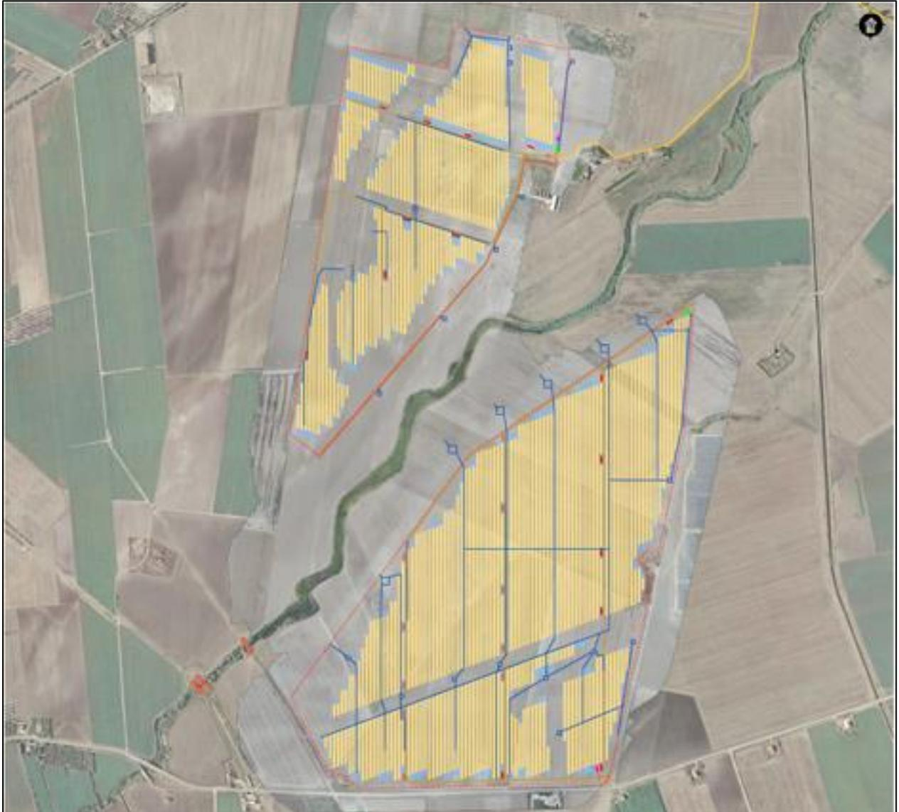
Figura 2.9: Layout dell'Impianto, in blu sono evidenziate le opere di drenaggio.
