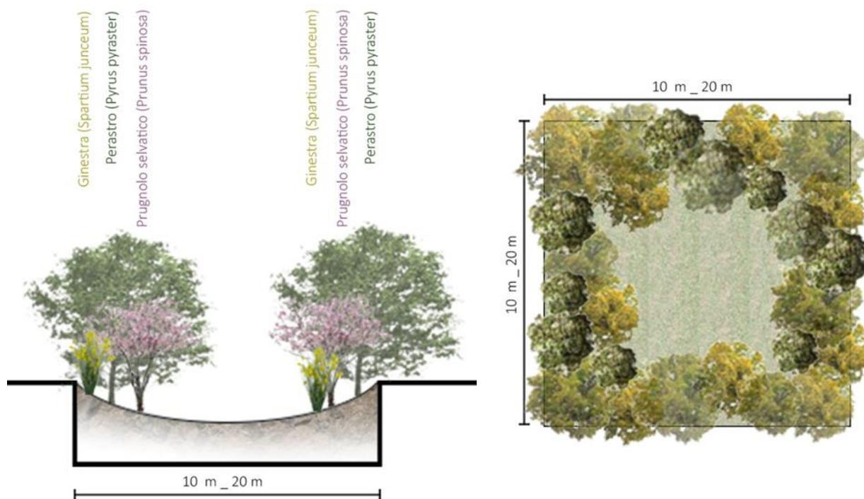
Figura 7.3: Tipologico del bacino di laminazione e infiltrazione.
