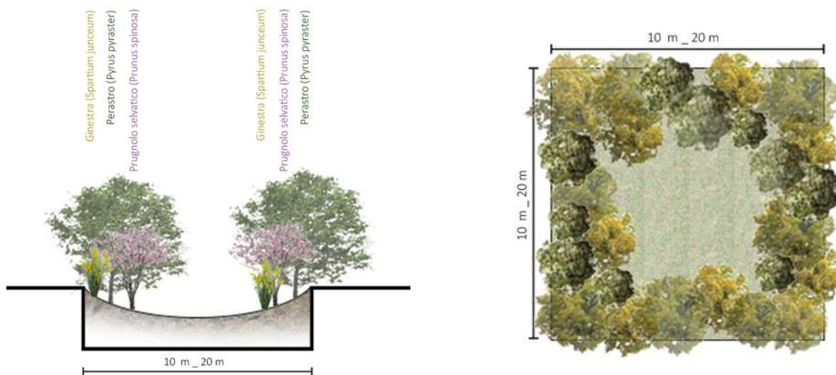
Figura 4.7: Tipologico del bacino di laminazione e infiltrazione.
