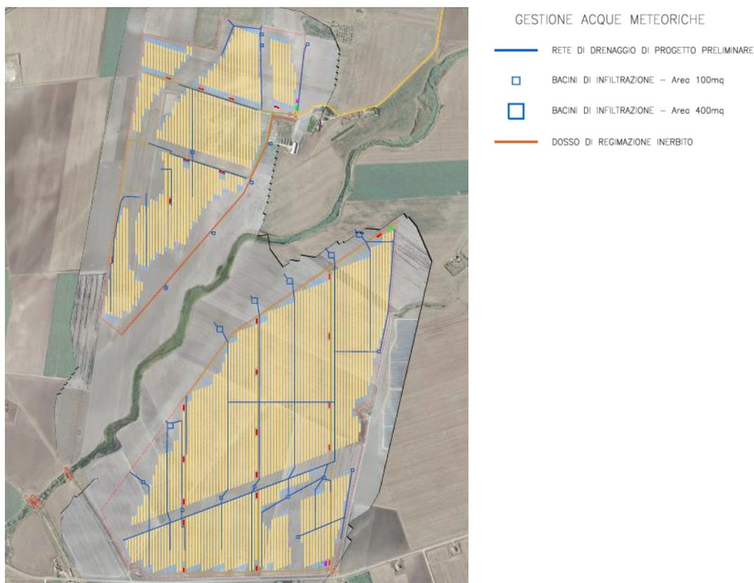
Figura 4.8: Localizzazione dei bacini di laminazione infiltrazione
