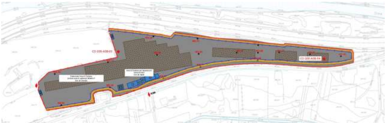
Figura 14 - Susa: Localizzazione delle postazioni per il monitoraggio delle fibre di asbesto
