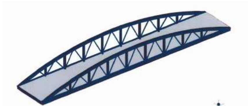
Figura 3 – Modello 3D del ponte ad arco previsto dal progetto definitivo in variante.
