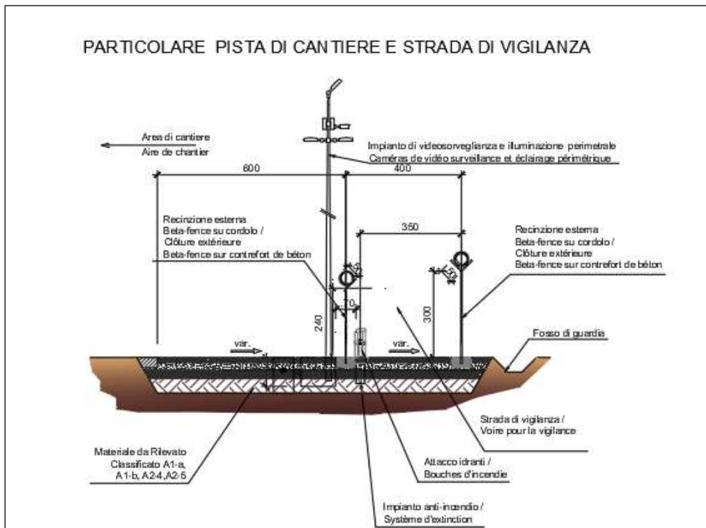
Figura 3 – Sezione tipologica viabilità perimetrale
