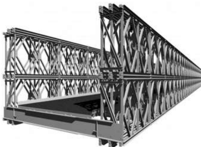
Figura 1- Attrezzatura da ponte con triplo doppio pannello (Triple Double Reinforced)
