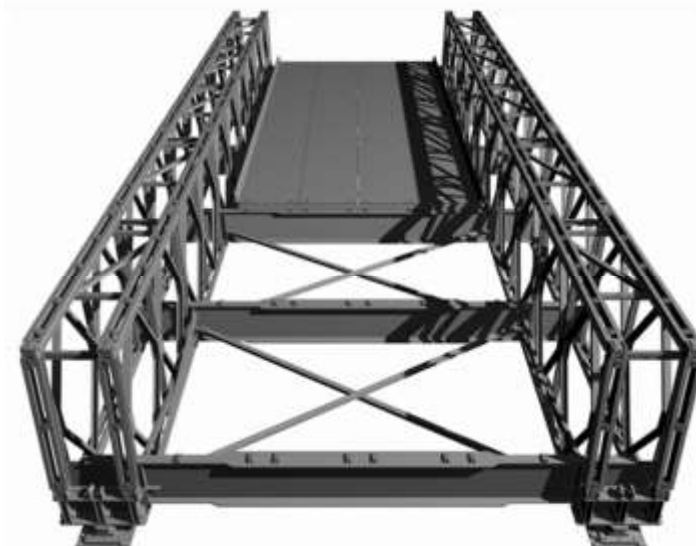
Figura 4 - Attrezzatura da Ponte a doppio pannello
