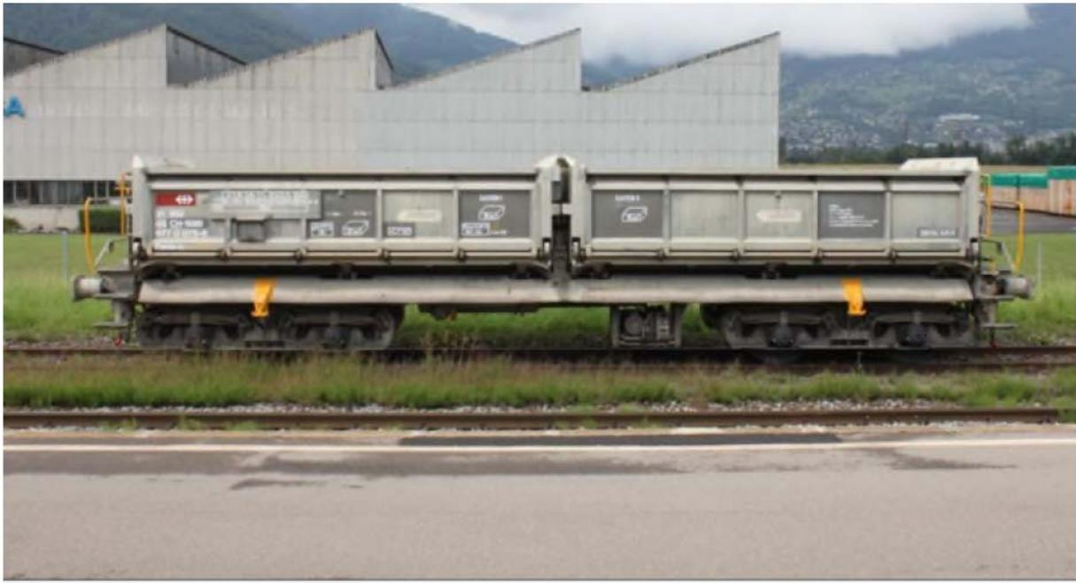
Figura 12- – Carro con ribaltamento laterale
