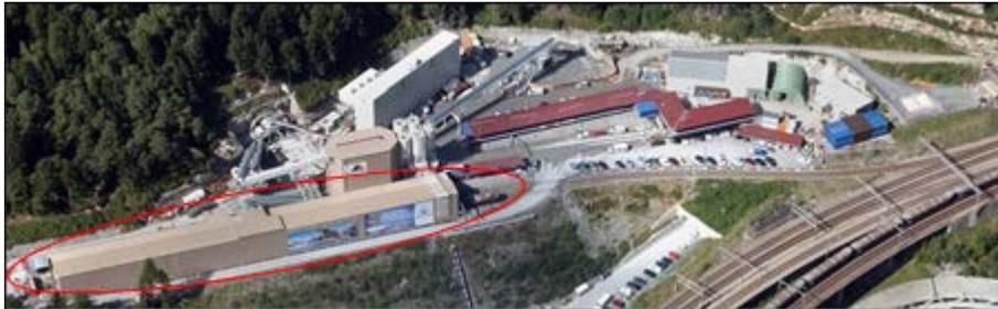
Figura 11- – Cantiere del Loetschberg – Impianto di caricamento con tramogge distribuite lungo l'intero fascio binari
