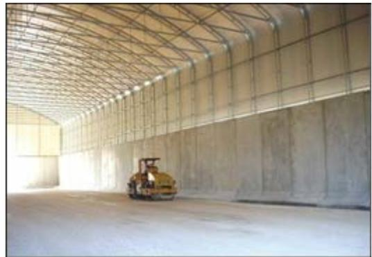
Figura 7- – Esempio di area di stoccaggio con copertura tipo “tenso-struttura”
