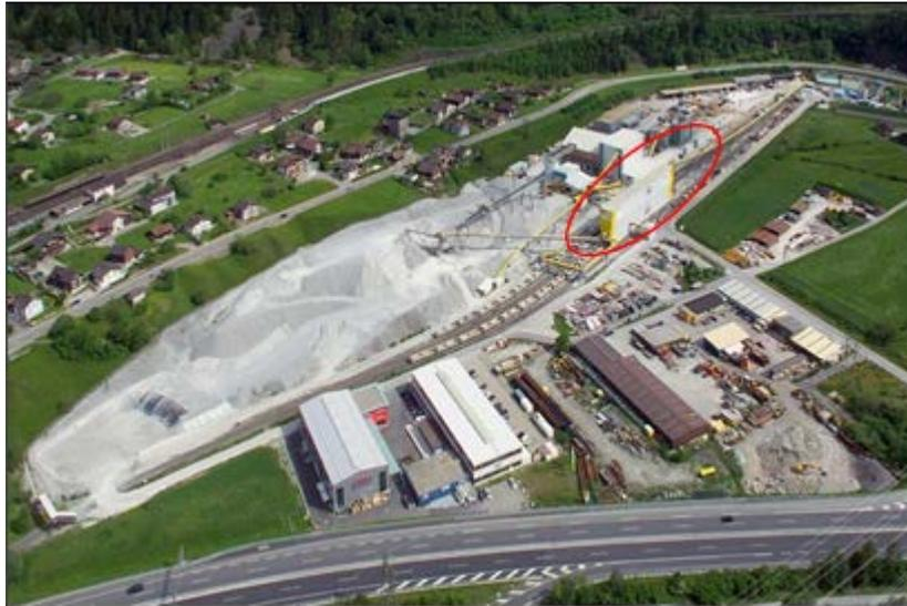
Figura 10- – Cantiere AlpTransit (Amsteg) – Impianto di caricamento dei materiali di scavo su treno- L'impianto è completamente schermato (cerchiato in rosso).
