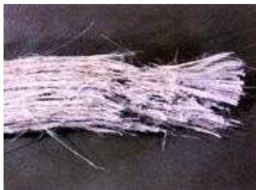
La pericolosità consiste, infatti, nella capacità che i materiali di amianto hanno di rilasciare fibre potenzialmente inalabili ed anche nella estrema suddivisione a cui tali fibre possono giungere. Tale conformazione, con tutti i vantaggi del caso, ha generato le molteplici applicazioni di questo
