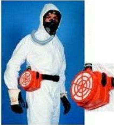
I sistemi di ventilazione assistita antipolveri forniscono all'utilizzatore aria ambiente opportunamente filtrata. Sono costituiti da: una unità ventilante alimentata da batteria a 6 volt (4 Ah) completa di tubo di collegamento alla maschera un filtro polveri ad alta efficienza TMP3, sostituibile.
