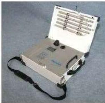
L'apparecchio per gli analisi d'aria airsampler permette ad aspirare un volume del flusso definito tramite un filtro per le prove d'aria. L'elaborazione dei filtri avviene nel laboratorio.
