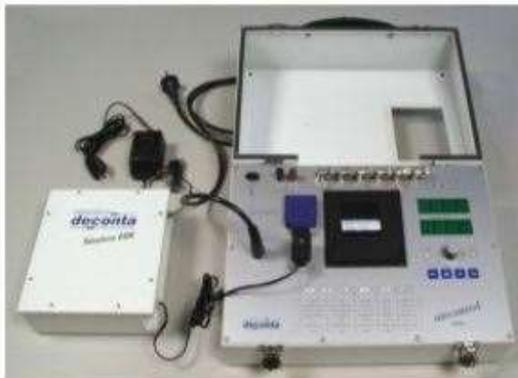
Per mezzo del cellulare GSM l'apparecchio permette di trasmettere due messaggi d'allarme, tramite i due allacciamenti d'allarme, fino a nove numeri di telefono. Durante l'accensione è controllata il collegamento GSM.
