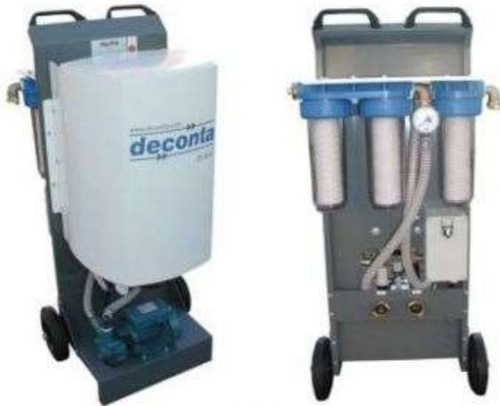
Cisterna elettronica per il riscaldamento dell'acqua calda per la doccia e sistema filtrazione acque di scarico. Azionando la cisterna l'acqua viene riscaldata e tramite un miscelatore si ottiene la temperatura desiderata per l'acqua della doccia (regolata dal produttore a 37° C). L'acqua di scarico viene pompata e filtrata in 3 stadi.
