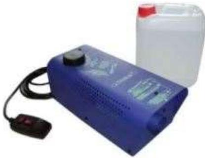
Apparecchiatura compatta ma di notevole resa. Il serbatoio viene caricato con il liquido; premendo il pulsante di erogazione, l'operatore fa sì che il fluido scorra in una camera riscaldata e venga vaporizzato.
