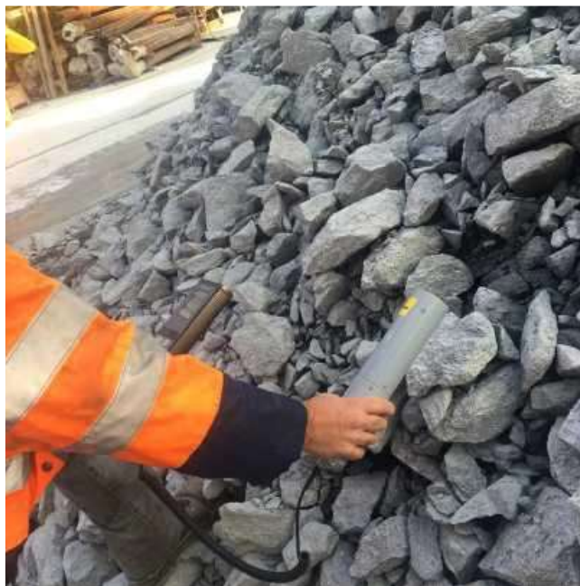
Figura 1: Esempio di misura gamma con sonda a scintillazione su cumulo di smarino
