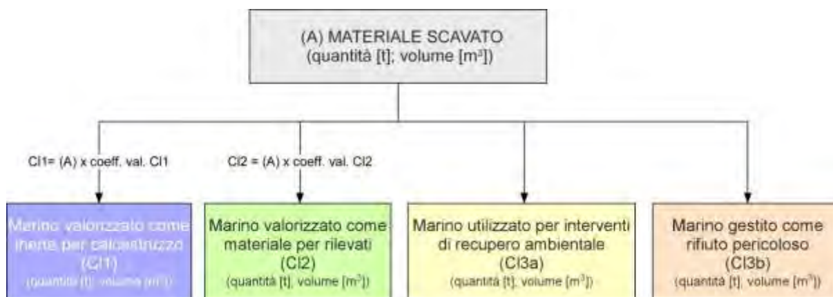
Figura 27 – Schema adottato per la gestione del marino in funzione delle possibilità di utilizzo definite sulla base delle indagini condotte.
