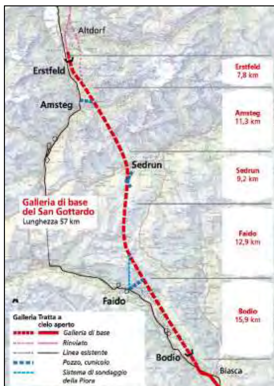
Figura 5 – Sviluppo lineare del Tunnel del San Gottardo (AlpTransit, Alp Transit Gotthard - Nuove vie di transito attraverso il cuore della Svizzera, 2012)
