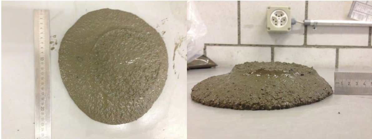
Figure 3. Evolution temporelle du mortier. Ce mortier est de qualité. Il reste compact, de forme homogène ne ségrège et ne dessue pas. En comparaison aux résultats obtenus avec l'autre CEM IV, ce mortier présente un temps d'affaissement, un affaissement et une consistance moindre.
