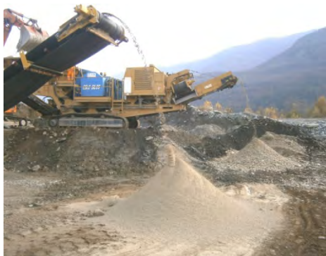
Foto n°4 – Gneiss così umido da formare un cono. Durante l'operazione di vagliatura, difficoltà a separare il fine dai grani per l'elevata umidità del materiale
