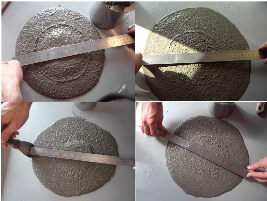
Figure 3. Evolution de la consistance du mortier dans le temps. Avant la réaction de l'adjuvant (image en haut à droite), le mortier est de consistance très compacte. Par la suite, le mortier devient plus malléable et son ouvrabilité augmente et reste constante dans temps.
