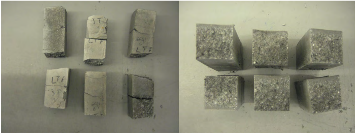
Figure 3 : Prisme TELT après la compression.
